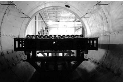
写真7.12 オートクレーブ硬化
