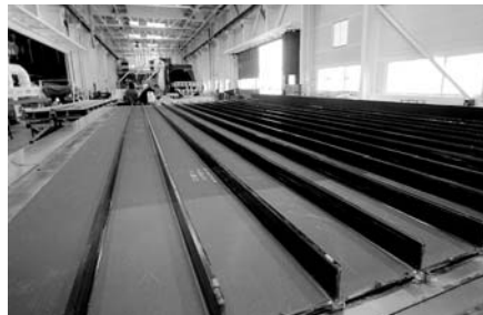
写真7.13 CFRP中央翼パネル
