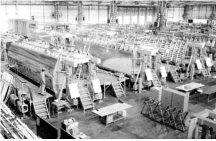
(a) 据置型構造組立治具による組立
