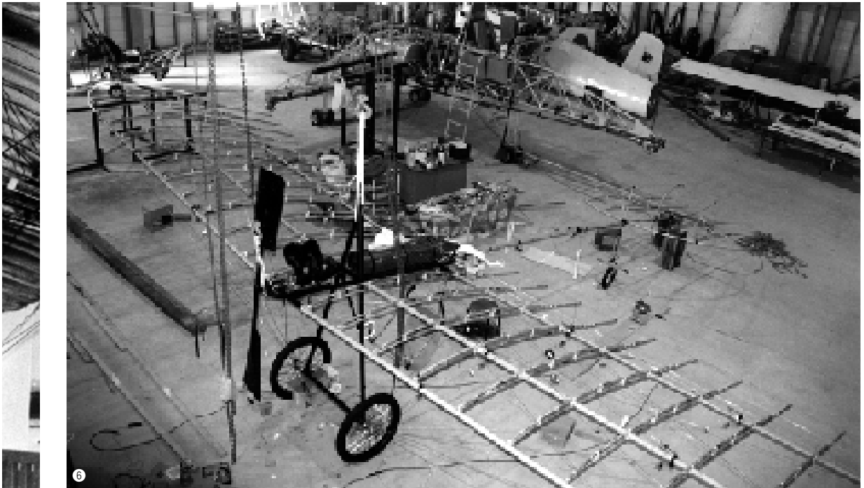
写真5 マクデブルグ都市記念博物館のグラード機 写真6 上から見たグラード機レプリカの全体構造 写真7 横から見たグラード機レプリカの全体構造
